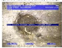
Joint displaces longitudinally, longitudinal displacement 16-2800
